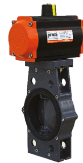
شیرهای پروانه ای U-PVC به همراه محرک بادی
